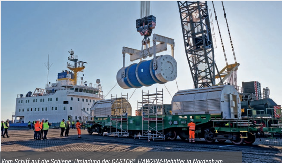
Vom Schiff auf die Schiene: Umladung der CASTOR® HAW28M-Behälter in Nordenham.
