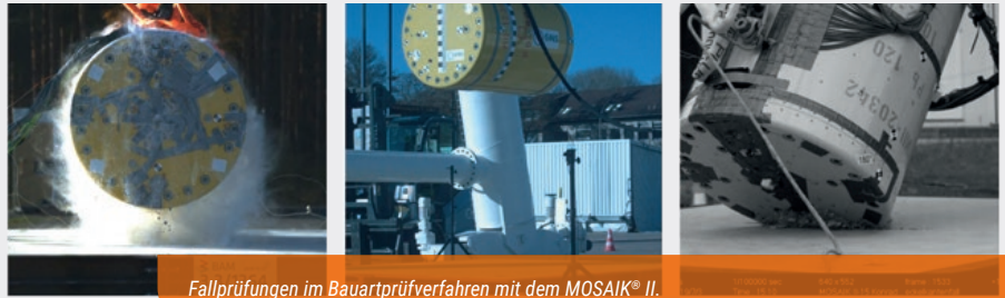
Fallprüfungen im Bauartprüfverfahren mit dem MOSAIK® II.
