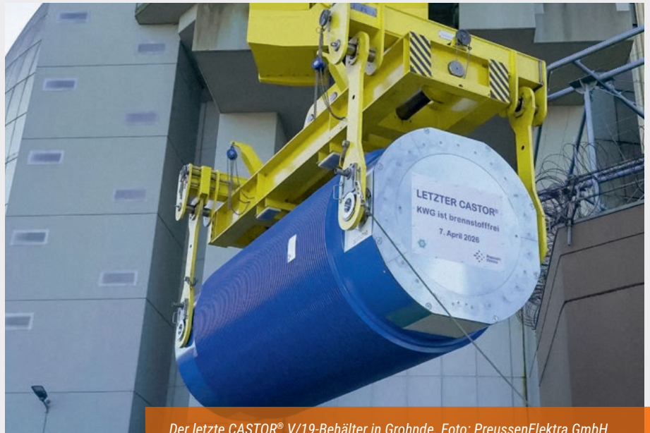
Der letzte CASTOR® V/19-Behälter in Grohnde. Foto: PreussenElektra GmbH
