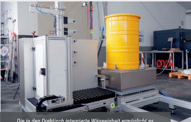
Die in den Drehtisch integrierte Wägeeinheit ermöglicht es, das Fassgewicht zu ermitteln.
