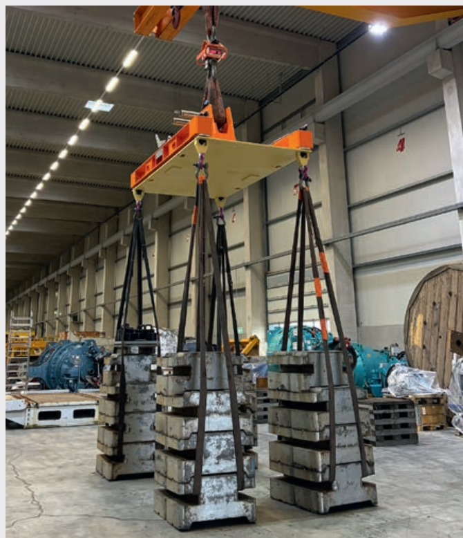
Die KC-Spreader haben den 30-Tonnen-Überlasttest mit Bravour bestanden.
