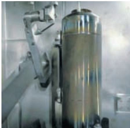
Glaskokille beim Wischtest zum Nachweis der Kontaminationsfreiheit. Alle rückzuführenden WA-Abfälle einschließlich der zukünftig herzustellenden CSD-B sind dieser Prüfung zu unterziehen.
