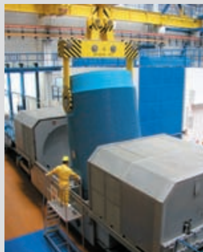
CASTOR® 440/84M beim Umladen im Zwischenlager Dukovany
