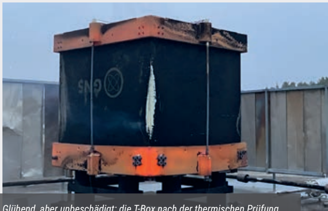
Glühend, aber unbeschädigt: die T-Box nach der thermischen Prüfung.
