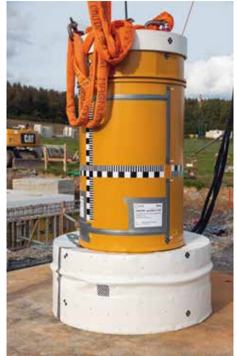
Prüfmuster nach dem 9 m-Deckelflachfall.
