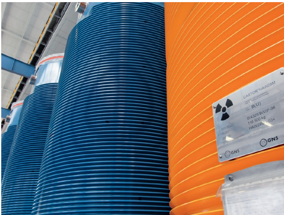
Ein CASTOR® HAW28M für die Rückführung verglaster Wiederaufarbeitungsabfälle neben CASTOR® V für bestrahlte Brennelemente in der GNS-Behälterfertigung in Mülheim.
