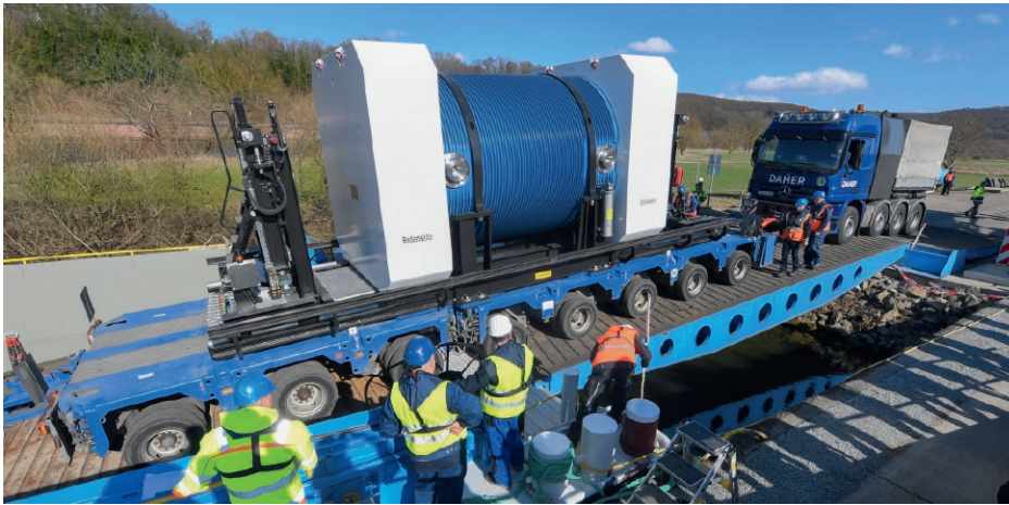
Erster Funktionstest im Februar 2017: In Obrigheim wird ein unbeladener CASTOR®-Behälter auf einem Universaltransportgestell auf das Transportschiff gefahren.
