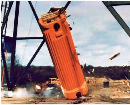
BAM-Testgelände in Lehre 1978: Erste 1:1-Falltests mit einem CASTOR® 1a Prototyp.
