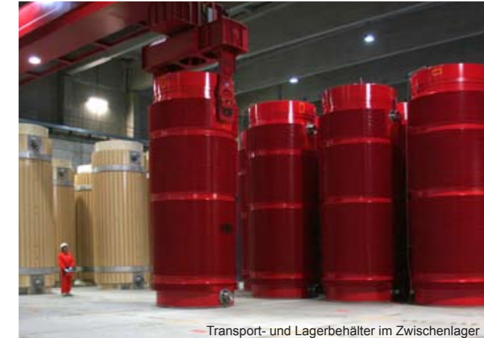
Transport- und Lagerbehälter im Zwischenlager
