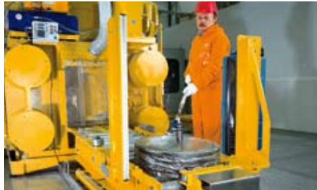
Konditionierung von Abfällen
